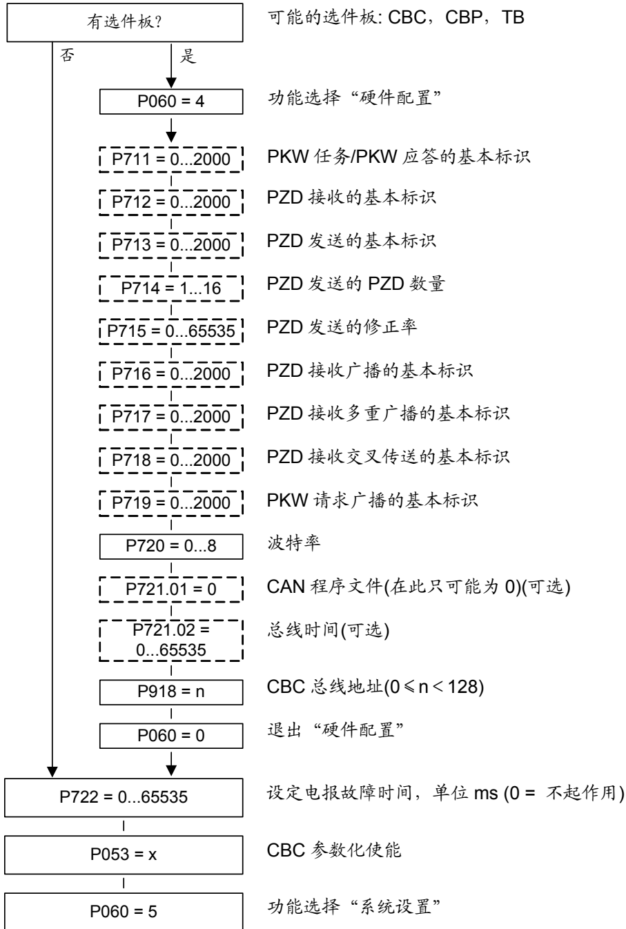
图 8.4-16 带 CUPM, CUMC 或 CUVC 的 MASTERDRIVES “硬件配置” 的参数化
