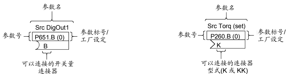
图 4-7 具有 16 位或 32 位字长的连接器
